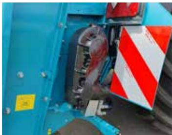
**Réglez aisément la tension du tapis** avec les tendeurs semi-automatiques de compensation, à ressorts ou hydrauliques\*.
