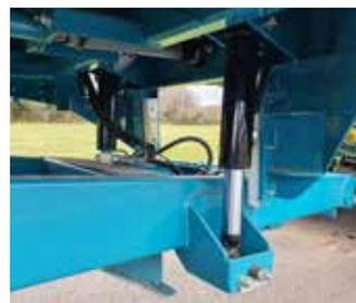
**Pour un confort maximal sur route et au champ**, optez pour une suspension de flèche hydraulique\* Anneau boulonné en standard.
