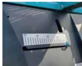
**Contrôlez visuellement la hauteur de trappe** grâce à l'indicateur présent sur le capot avant\*.
