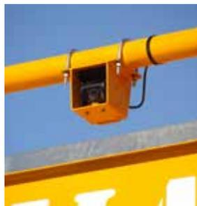
**Contrôlez l'épandage,** les manœuvres, les voies publiques ou encore le bon déroulement du travail avec la caméra sur cadre ou sur panneau avant.
