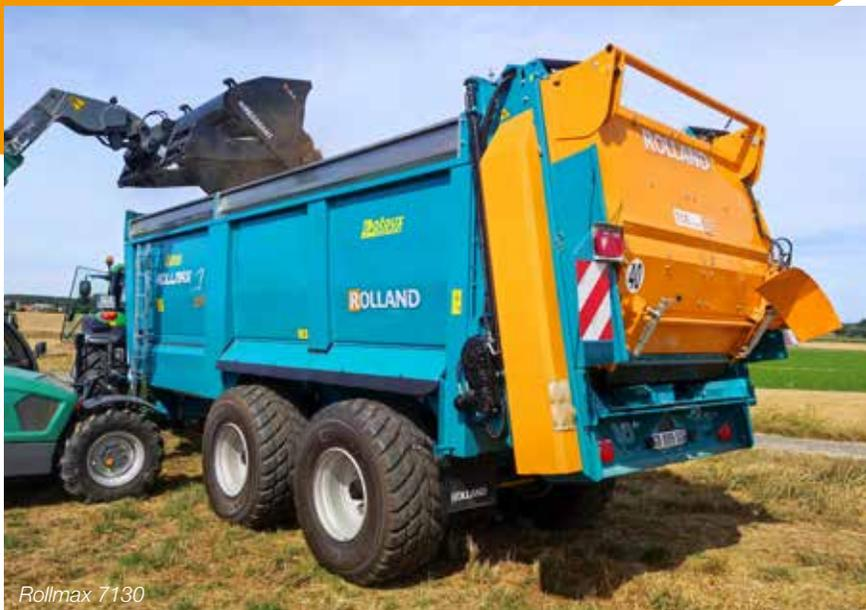
**Pour une utilisation extrême :** table TCEi HD, boîtiers 200 cv, pièces d'usure démontables en HARDOX et disques 4 pales avec sécurités.
