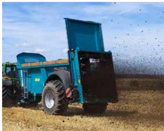
**Ajuster facilement le tonnage/ hectare** avec la trappe régulatrice de produits\*.
